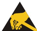
bedeutet, dass entsprechende ESD-Schutzmaßnahmen nach DIN EN 61340-5-1 Beiblatt 1 zu beachten sind.
