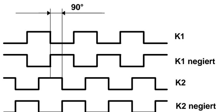
Soll der Inkrementalzähler die gleiche Auflösung wie die Kassette haben, muß eine vierfache Auswertung der Inkrementalspuren erfolgen.
